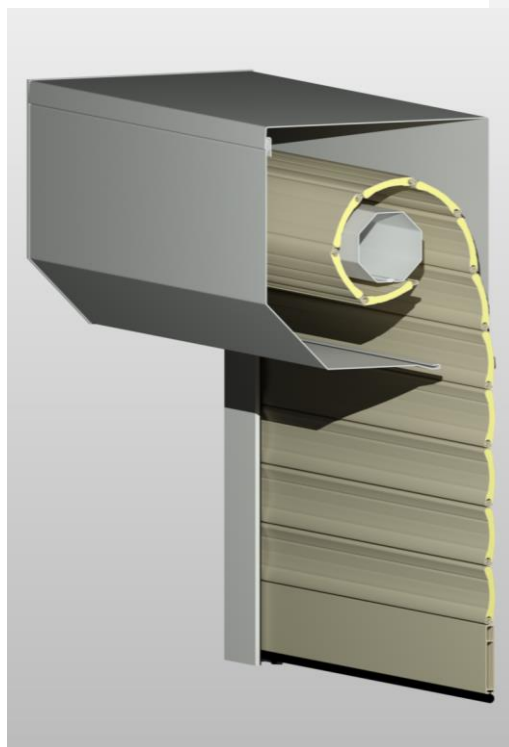
Otwieranie kłapy rewizyjnej oraz przekrój
